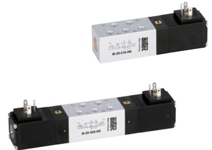
Elektrisch betätigtes Kolbenschieber-Ventil. Nach Zuschalten der Spannung wird das Ventil umgesteuert. Die Ventile sind mit einer rastenden Handhilfsbetätigung ausgestattet. Die Betätigung erfolgt mittels Schraubendreher.
