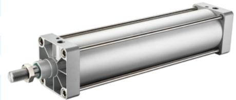
Doppelwirkender Pneumatikzylinder, beidseitig mit einstellbarer, pneumatischer Endlagendämpfung. Mit Positionserkennung zur berührungslosen Stellungsabfrage mit Zylinderschaltern. Sonderhublängen sind auf Wunsch lieferbar.
