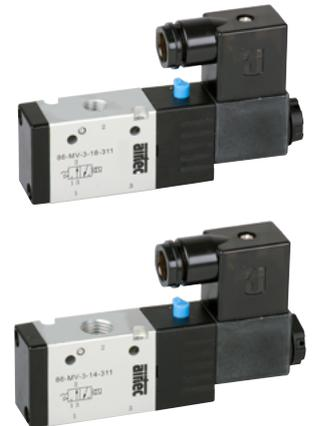
Elektrisch betätigtes Kolbenschieber-Ventil. Nach Zuschalten der Spannung wird das Ventil umgesteuert. Die Ventile sind mit einer tastend-/ rastenden Handhilfsbetätigung ausgestattet. Die Betätigung erfolgt mit Hand oder mittels Schraubendreher.
