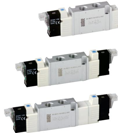
Elektrisch betätigtes Kolbenschieber-Ventil. Nach Zuschalten der Spannung wird das Ventil umgesteuert. Die Ventile sind mit einer tastend-/ rastenden Handhilfsbetätigung ausgestattet. Die Betätigung erfolgt mittels Schraubendreher.
