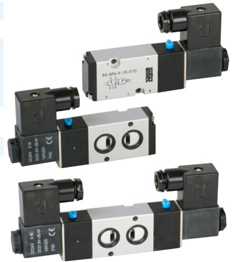
Elektrisch betätigtes Kolbenschieber-Ventil. Nach Zuschalten der Spannung wird das Ventil umgesteuert. Die Ventile sind mit einer tastend-/ rastenden Handhilfsbetätigung ausgestattet. Die Betätigung erfolgt mit Hand oder mittels Schraubendreher.
