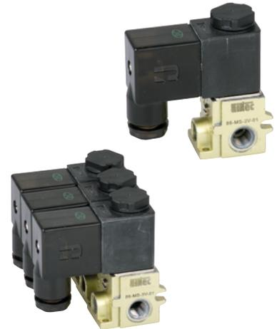
Elektrisch betätigtes Sitzventil. Nach Zuschalten der Spannung wird das Ventil umgesteuert. Die Ventile sind mit einer rastenden Handhilfsbetätigung ausgestattet. Die Betätigung erfolgt mittels Schraubendreher. Zur Verbindung mehrerer Einzelventile steht das **Montage-Set 21-MS-3V-01** zur Verfügung.
