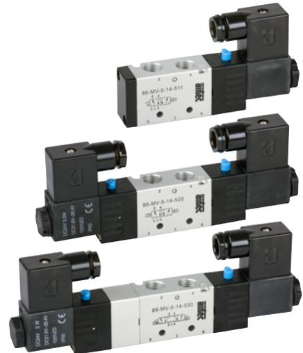
Elektrisch betätigtes Kolbenschieber-Ventil. Nach Zuschalten der Spannung wird das Ventil umgesteuert. Die Ventile sind mit einer tastend-/ rastenden Handhilfsbetätigung ausgestattet. Die Betätigung erfolgt mit Hand oder mittels Schraubendreher.
