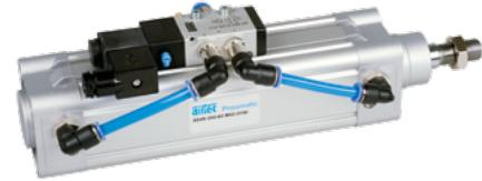
Doppeltwirkender Pneumatikzylinder, beidseitig mit einstellbarer, pneumatischer Endlagendämpfung. Mit Positionserkennung zur berührungslosen Stellungenabfrage mit Zylinderschaltern. Sonderhublängen sind auf Wunsch lieferbar.
