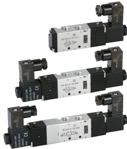
Elektrisch betätigtes Kolbenschieber-Ventil. Nach Zuschalten der Spannung wird das Ventil umgesteuert. Die Ventile sind mit einer tastend-/ rastenden Handhilfsbetätigung ausgestattet. Die Betätigung erfolgt mittels Schraubendreher.
